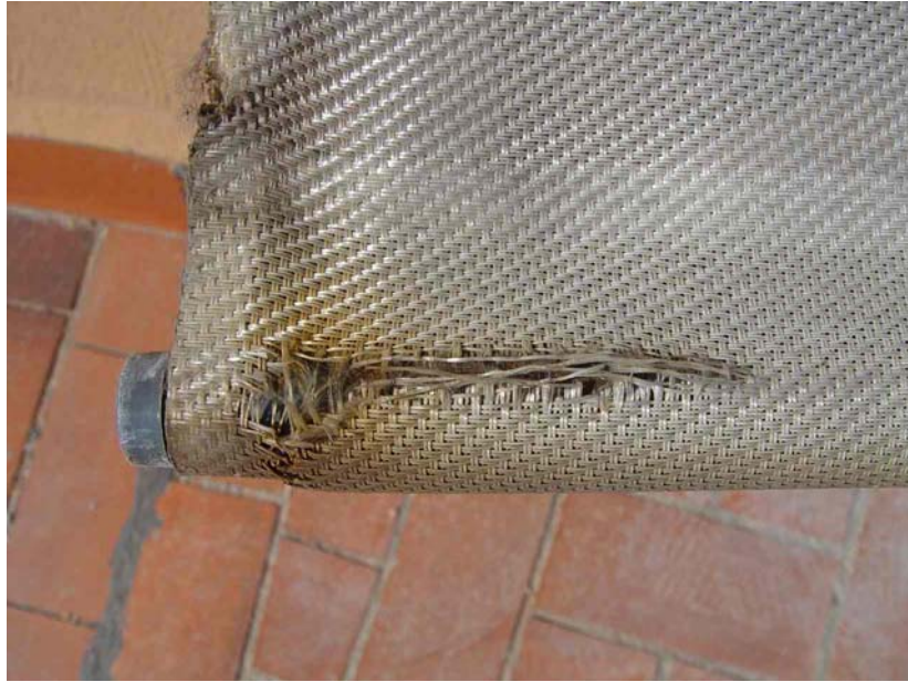
Figura 8. Fragilización de la fibra de vidrio
